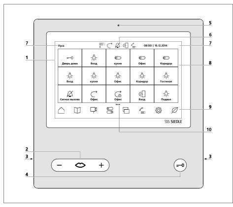
Видеопанель Ассеss отличается большим сенсорным экраном. Две кнопки имеют две базовые функции Разговор / Регулировка громкости и Отпирание дверей. Остальные функции реализуются с дисплея.
