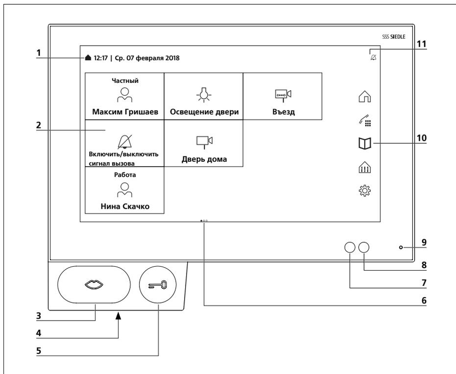
Siedle Axiom отличается большим сенсорным экраном. Две кнопки имеют два базовые функции «Разговор» и «Отпирание дверей». Остальные функции реализуются с дисплея.
